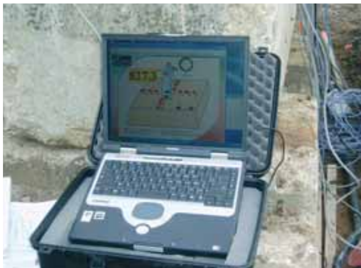
Pilotage informatique de l'essai d'arrachement Computer controller for the pull-out test
